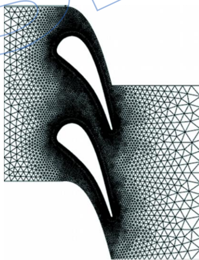
图 2 VKI 导叶计算网格 (S1ICH 生成)
